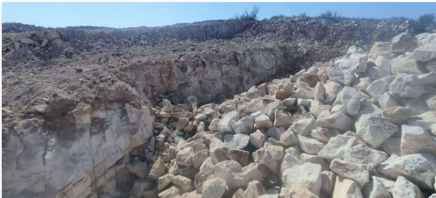
ترانشه استخراج — دیواره و کف جبهه کار به همراه کلوخه استخراجی
